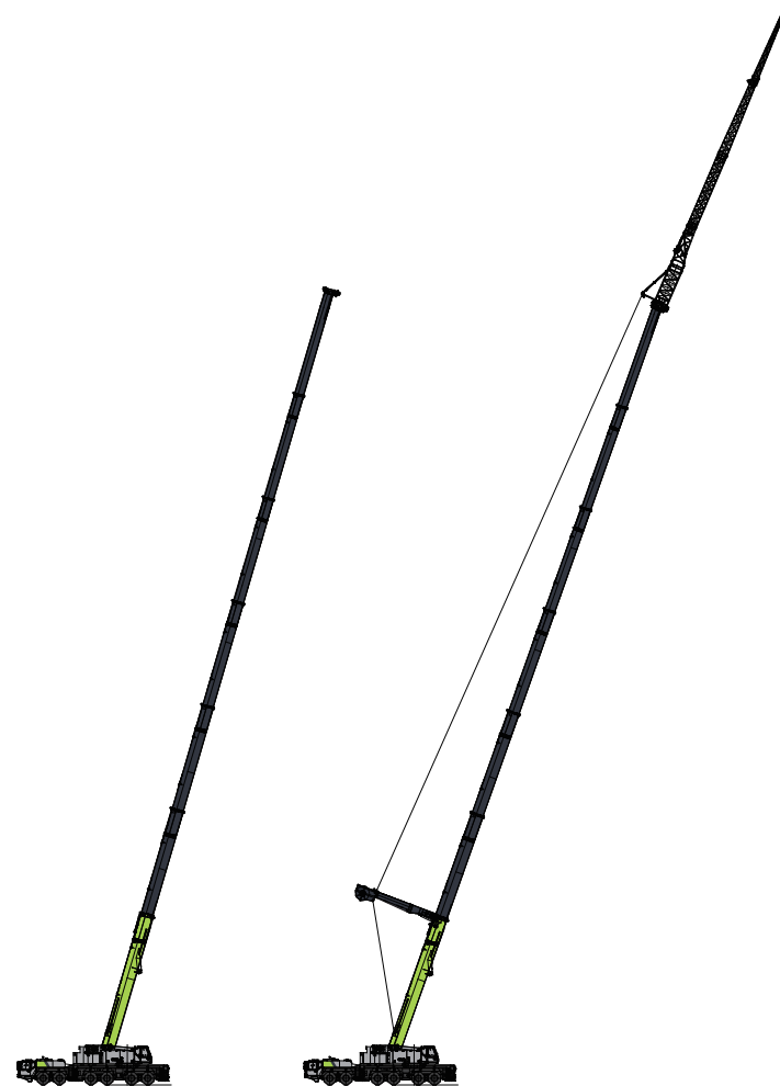
Jibs de serviço leve + Superlift Lança telescópica: 80m Jibs de serviço leve: 16m/24m/32m
