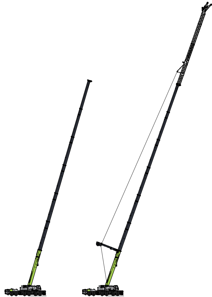
Jibs de serviço leve + Superlift Lança telescópica: 55m-80m Lança telescópica: 55m / 60m/65m Jibs de serviço pesado: 9m/13m Jibs de serviço pesado: 16m/24m/32m
