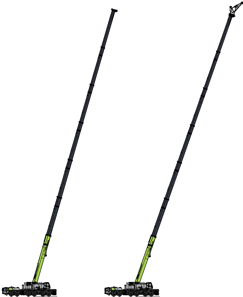
Jib de montagem Lança telescópica: 15,4-80m Jib de montagem: 4,5m
