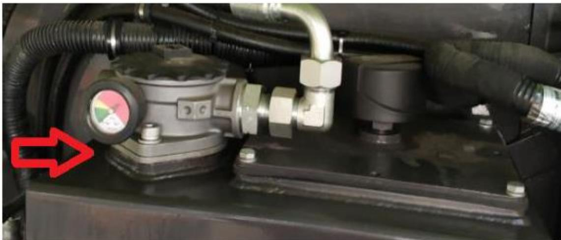
Ponto(s) de Manutenção – Elemento substituível
