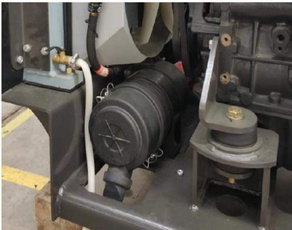
Ponto(s) de Manutenção – Elemento substituível
