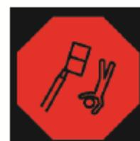
Indica falhas no sistema de nivelamento eletrônico. O indicador pisca e o alarme soa. Se a lança estiver elevando, o modo de marcha lenta é ativado automaticamente.
