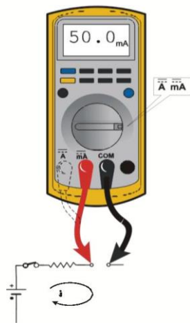
Figura 7-4 Medição da corrente (corrente direta)
