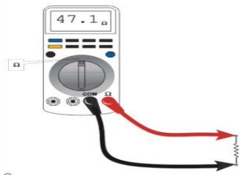
Figura 7-2 Medição de resistência
