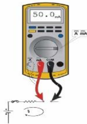
Figura 7-4 Medição de corrente (corrente direta)
