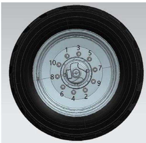
Imagem 4-2 Sequência de aperto das porcas de fixação da roda
