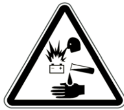
Imagem 1-6 Preste atenção ao fluido da bateria
