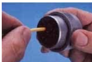
Imagem 7-7 Instalação do contato HD/HDP
