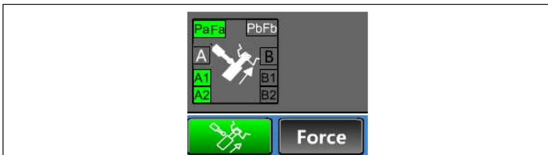
Figura 4-49 Teclas de função e status do ícone, estendendo o cilindro de tensionamento
