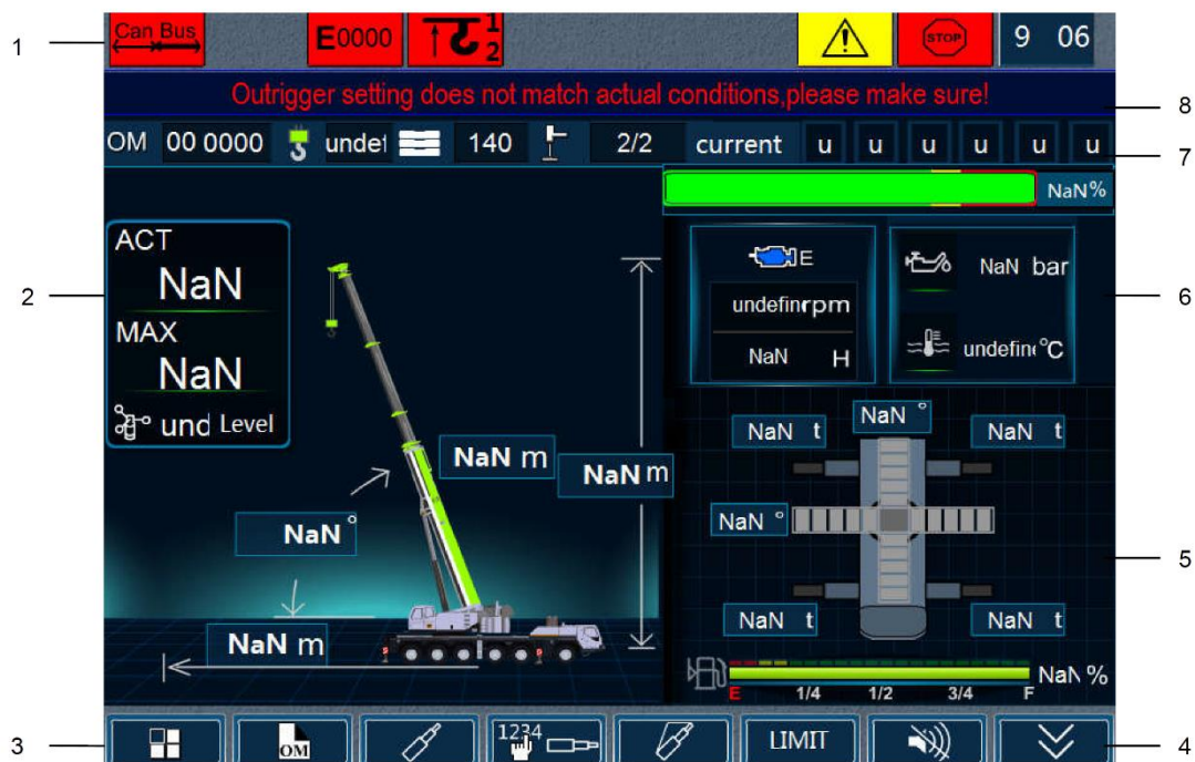
Figura 4-12 Interface de monitoramento do status de trabalho do guindaste
