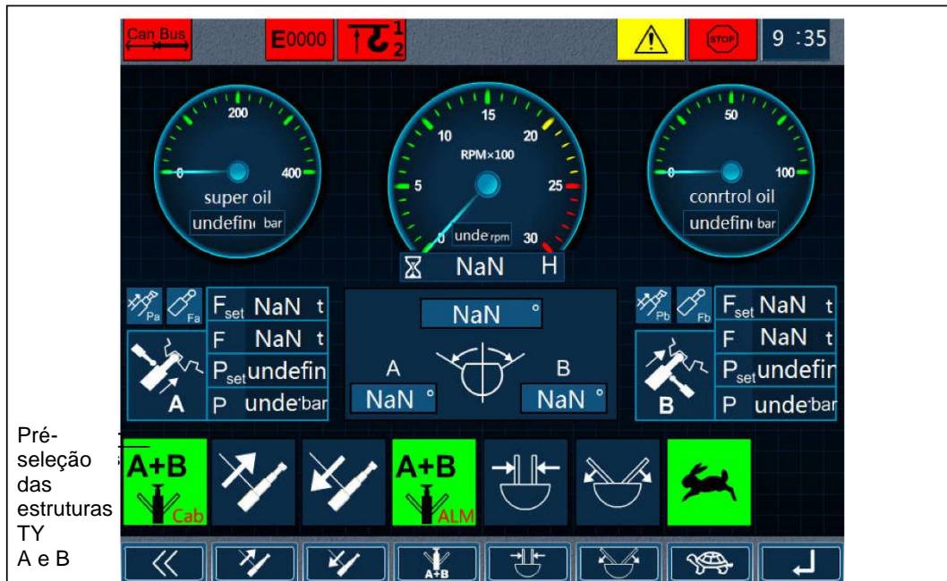
Figura 4-38 Movimentação da lança, abertura e fechamento das estruturas TY
