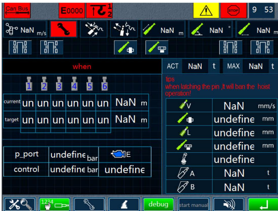
Figura 4-58 Status de lança durante telescopagem manual
