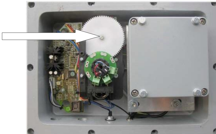
Figura 4-10 Ajuste do eixo intermediário do potenciômetro de comprimento
