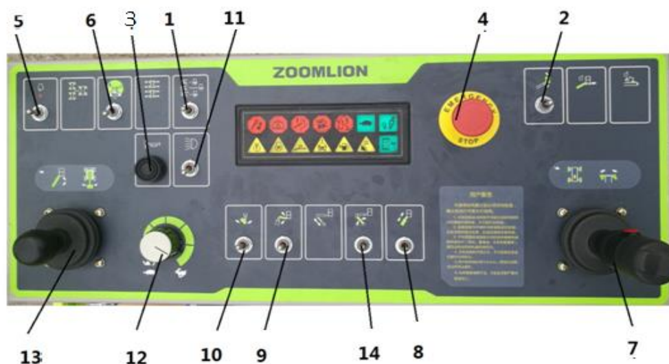
Imagem 2-12 Painel de controle da plataforma (somente é identificado o número de série do interruptor correspondente à função existente)
