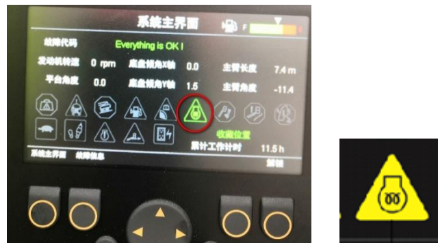
Figura 5-17 Luz indicadora de trabalho do plugue de pré-aquecimento
