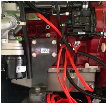
Figura 5-18 Aquecedor elétrico adicionado ao motor (opcional)
