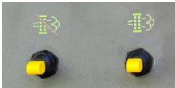
Figura 5-16 Botão de regeneração de proibição do DPF e botão de regeneração
