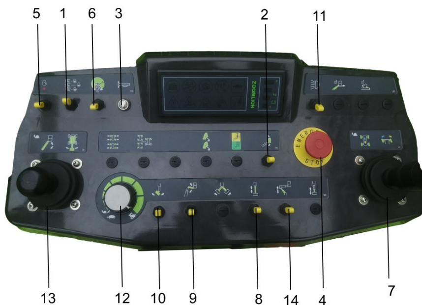
Imagem 2-7 Painel de controle da plataforma (somente é identificado o número de série do interruptor correspondente à função existente)
