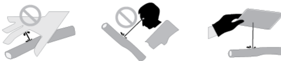
Imagem 1-5 Atenção ao óleo de alta pressão para prevenir queimaduras
