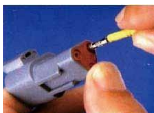
Imagem 7-6 Remoção da tira de contato DT/DTP
