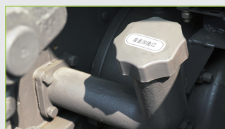
Enchimento do tanque de combustível do chassi
