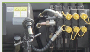
Três conjuntos de saídas hidráulicas com função de fixação
