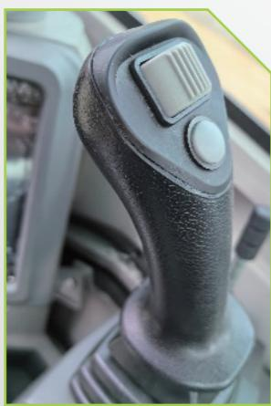
**JOYSTICK ELÉTRICO PROPORCIONAL PARA MÁQUINA DE ALTA CONFIGURAÇÃO**
