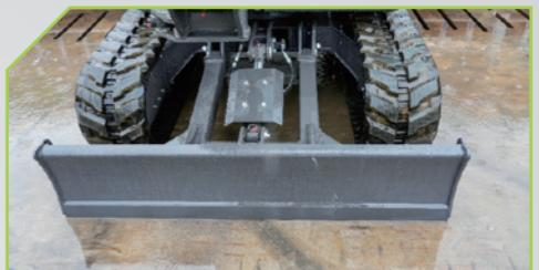
A tubulação da lâmina niveladora é equipada com uma placa protetora para enfrentar condições de trabalho difíceis, protegendo simultaneamente o cilindro e a linha.
