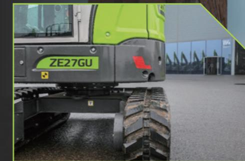
Um dos destaques da ZE27GU é o giro zero de traseira: seu raio de giro não ultrapassa a largura da esteira no estado totalmente expandido. Esse design significa que ela pode trabalhar em espaços estreitos e em ruas movimentadas, sem limitação de espaço.
