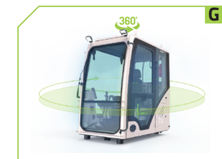
Excelente visibilidade em todas as direções graças às grandes áreas de vidro, com transmittância do vidro aumentada em mais de 11%. Os clientes podem escolher o protetor solar.
