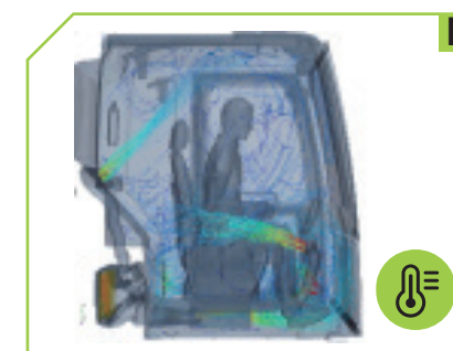
Comparado com a cabine da geração anterior, o efeito de resfriamento da cabine da nova geração é aumentado em mais de 19%
